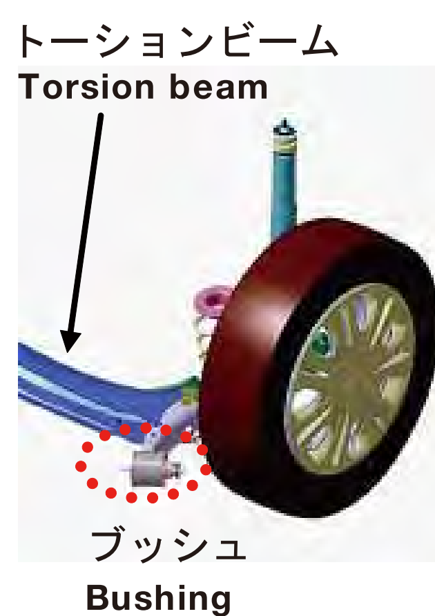
リアトーシヨンビームサスペンション Rear torsion beam suspension
